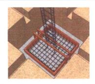
Sapatas executadas em concreto armado de fck = 30Mpa, utilizando-se aço CA 50 e/ou CA 60, assentadas sobre base de concreto magro espessura de 5cm, escavação mecanizada, fabricação, montagem e desmontagem de fôrma em madeira serrada de espessura 25mm. Conforme indicado em Projeto Estrutural.
