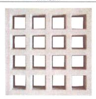
Alvenarias com elementos vazados deverão ser executadas em Cobogó de concreto de dimensão 50x50x7cm com acabamento polido em ambos os lados, assentados através de argamassa preparada em betoneira. O assentamento será iniciado pela extremidade (cantos), colocando a primeira fiada do cobogó sobre uma camada de argamassa previamente executada.
