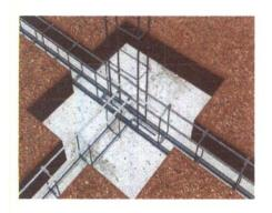
Baldrames executadas em concreto armado fck= 30 Mpa. As formas deverão ser plana, em compensado resinado de 12mm, inclusive escoramento. A armadura deverá estar completamente limpa de qualquer impureza prejudicial à aderência do concreto, sendo colocadas respeitando o cobrimento conforme especificado em projeto, utilizando-se aço CA 50 e/ou CA 60, fabricação, montagem e desmontagem de forma em madeira serrada de espessura 25mm. Conforme indicado em Projeto Estrutural.
