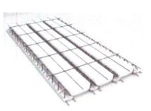
Lajes pré-moldadas em concreto armado deverão seguir fabricação e montagem conforme dimensões especificadas em projeto estrutural. As vigotas serão do tipo treliçado, dimensionadas de acordo com vãos e carregamentos, utilizando blocos de enchimento em EPS, com armadura negativa, capa em concreto com espessura mínima de 5 cm e fck = 30Mpa.
