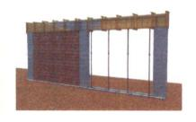
Vigas executadas em concreto armado de fck=30Mpa e moldados in loco conforme dimensões especificadas em projeto estrutural, utilizando-se de aço CA 50 e/ou CA 60, montagem e desmontagem de fôrma em chapa de madeira compensada e resinada de 18mm, através de escoramento com pontalete de madeira, pé-direito simples, em madeira serrada.
