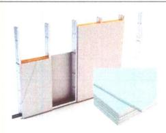
Alvenarias de vedação em divisórias de gesso acartonado (drywall tipo RU) que deverão ser instaladas utilizando estruturas de perfis de aço galvanizado, parafusando a chapa de drywall RU sobre esses perfis. Tratamento das juntas: deverão ser realizadas com fita de papel microperfurado, massas específicas e cantoneiras especiais, de acordo com as técnicas especificadas pelo fabricante.
