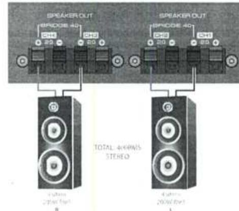
**Exemplo 3:** Oito arandelas de 4 ohms funcionando em stereo para duas salas comerciais:
