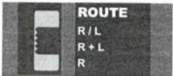
**R/L:** Direciona o canal L para a saída CH3 e o canal R para a saída CH4. Esta configuração é indicada para ambientes na qual as caixas se encontram em posições adequadas para reprodução stereo.
