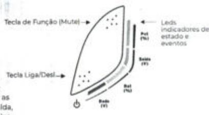
Através de um simples toque no botão é possível visualizar nos LEDs e no Display as informações de tensão de entrada, de saída, de potência instalada e de nível de baterias. É possível também visualizar eventos críticos e ocorrências tais como o envelhecimento das baterias, erros de operação, etc.
