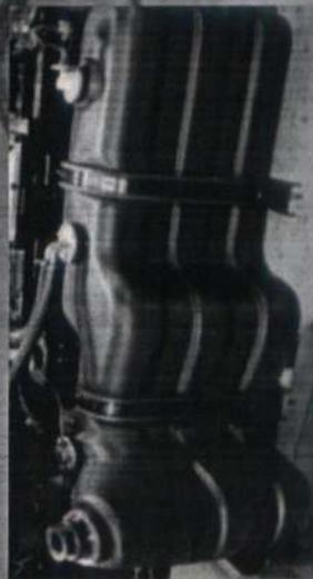
O trator 7790X está equipado com um tanque de combustível montado na parte inferior com grande capacidade e longas horas de operação.
