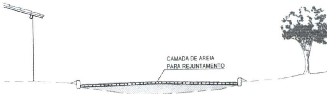
Antes da compressão com rolo metálico, joga-se areia sobre o calçamento, em quantidade suficiente para preencher as juntas e formar uma camada sobre o calçamento de aproximadamente 2cm.
